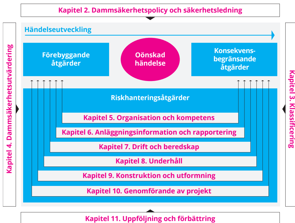
Bild 1. RIDAS struktur med riskhanteringsåtgärder för en dammanläggning i den inre rutan samt övergripande förutsättningar, klassificering, dammsäkerhetsutvärdering och uppföljning.
